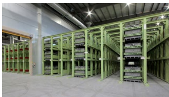
混練物を養生するための養生ラック
