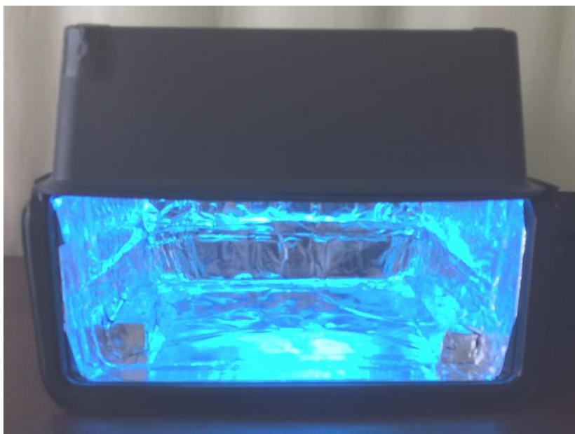
**殺菌灯ボックス** 上部の箱の中に殺菌灯が付けられている。足元のスイッチを踏むと、点灯する。
